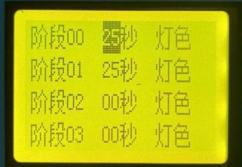
图示：0 阶段 配时 25 秒 （灯色->选中灯色项按确定键设置阶段 0 的放行方向）
